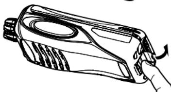
2 Para extraer la batería, suba el cierre de seguridad situado en la base del transceptor y luego presione la pestaña de liberación situada debajo de dicho cierre.
